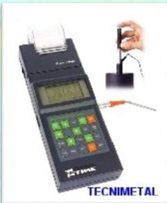
Durómetros portátiles de todo tipo de escalas Rockwell, Loop, Webster, Barcol, Shore,... incluso con impresora.
