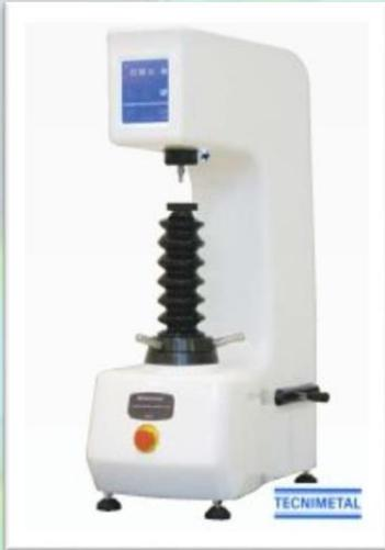
Durómetros de sobremesa desde los típicos ROCKWELL pasando por Brinell o los universales, hasta la medida de elastómeros e incluso geles.
