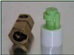
Los productos PLASTIFORM permiten la toma de réplicas en mecanizados internos complejos y su verificación y control en un instrumento de medida óptica (proyector, microscopio, máquina de visión...), así como la reproducción de exteriores. La reproducción alcanza precisiones de micra de precisión dependiendo del producto.
