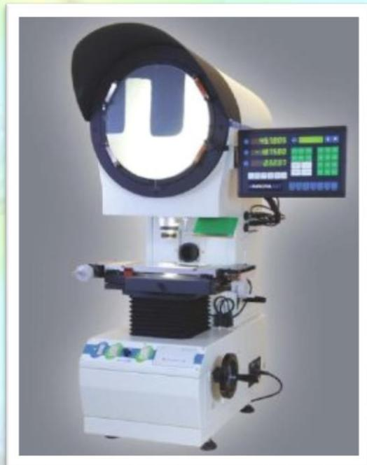
**Proyectores de perfiles** verticales y horizontales con imagen a derechas. Calculador geométrico salida de datos a ordenador...
