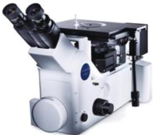
**Microscopio metalográfico invertido** Desarrollados especialmente para aplicaciones de rutina, en su diseño se ha puesto un particular énfasis en la comodidad de uso. Todas las funciones operativas usadas con mayor frecuencia son accesibles desde la parte frontal y el diseño las hace fácil de usar tanto si el operador está trabajando sentado como de pie.
