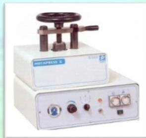
**Prensa metalográfica** automática con moldes intercambiables de  $\varnothing$  25.4 mm a  $\varnothing$  40 mm.
