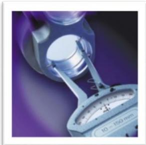
Verificador de interiores **Interapid IRA 2**. Dotado de sistema de centrado para medida en dos puntos.
