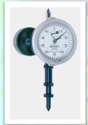
**Control de cigüeñales y muñequillas montados.** Control de salto en cigüeñales, holgura en los apoyos, etc.
