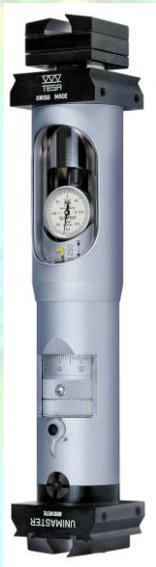
Instrumento para medida de grandes dimensiones interiores y exteriores **Tesa Unimaster**. Preciso, robusto y manejable. Estabilidad de las medidas garantizada por la poca flexión del instrumento. Contactos con recubrimiento de metal duro. Comparador de palanca integrado para la búsqueda del punto de inflexión.
