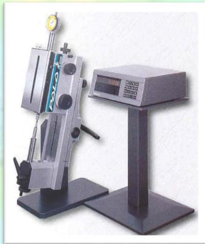
**Banco de medida horizontal de una coordenada.** Ideal para cumplir con los requisitos de calibración, según las normas ISO 9000, de comparadores, varillas calibradas, tampones roscados, tampones lisos, anillos lisos, calibres roscados, etc.
